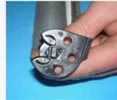
alten Spanner von der Walzenkapsel lösen
