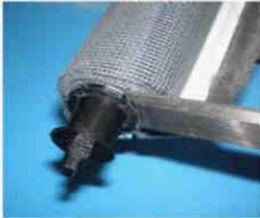
Gleitring von Welle auf beiden Seiten lösen
