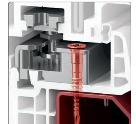
Sicherheitsschließteile werden mit Spezialschrauben im Stahlkern verschraubt. Der verstärkte Rahmen leitet die Kräfte ins Mauerwerk ab.
