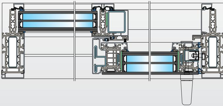
horizontaler Systemschnitt der Hebeschiebetür Cristal aus Aluminium
