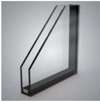
Unser Lieferstandard: Das Wärmeschutzglas Plus-Valor, ein Isolierglas aus zwei Scheiben. Eine Scheibe ist mit einer Wärmeschutzschicht versehen, der Scheibenzwischenraum mit isolierendem Argongas gefüllt.
