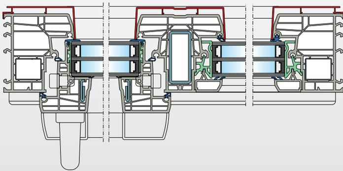
horizontaler Systemschnitt der Abstellschiebetür Top 90 Nova-line KAB-N aus Kunststoff-Aluminium
