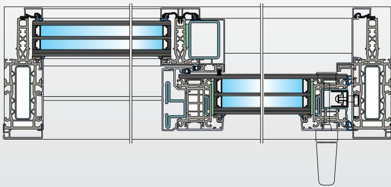
horizontaler Systemschnitt der Hebeschiebetür Nova aus Aluminium
