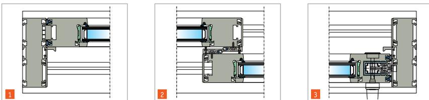
Hebeschiebetür aus Kunststoff mit fest eingeschraubtem Seitenflügel
