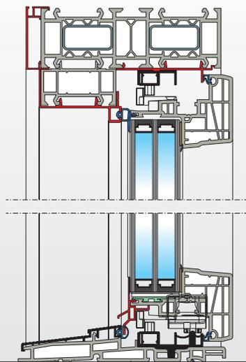
vertikaler Systemschnitt der Schiebetür Easy-Slide mit flacher Schwelle
